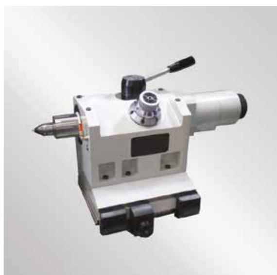
L'unità contropunta di **TITAN** dispone di tutto il necessario: movimento comandato manualmente da leva o automaticamente tramite pedale; spinta sul pezzo regolabile tramite molla o idraulica. La correzione della cilindricità dei pezzi avviene con un pratico pomello frontale dotato di scala ottica. Lo spostamento del gruppo lungo il banco fisso avviene tramite una cremagliera che agevola l'operatore nelle operazioni di setup.
